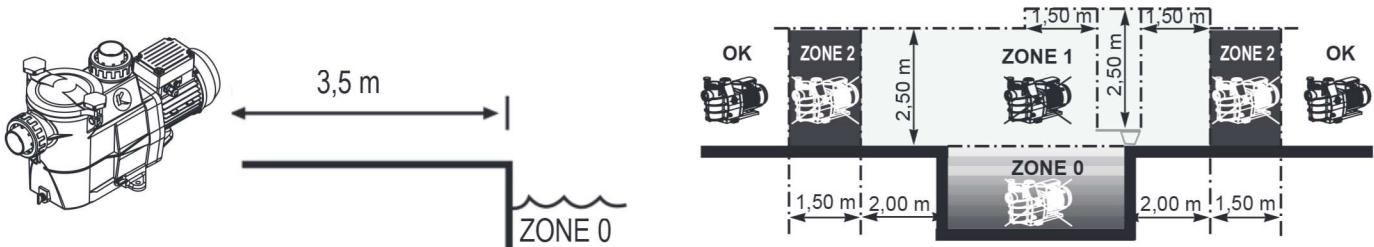
Installer la pompe dans un local ventilé et sec, le moteur exige que l'air circule librement autour de celle-ci pour permettre sa ventilation naturelle. Vérifier régulièrement que des objets, des feuilles ou tout autre encombrant ne viennent pas obstruer le refroidissement du moteur.
