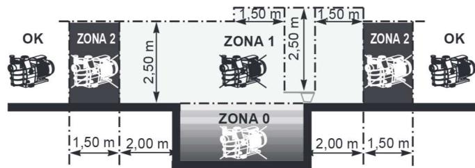
Instalar a bomba num local ventilado e seco; o motor precisa que o ar circule livremente à volta da bomba para permitir a sua ventilação natural. Verificar regularmente que objectos, folhas ou quaisquer outros elementos não obstruem a refrigeração do motor.
