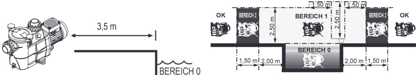
Pumpe an einem belüfteten, trockenen Ort aufstellen. Für einen ordnungsgemäßen Betrieb des Motors muss die Luft frei um die Pumpe zirkulieren können, um ihn auf natürliche Weise zu belüften. Regelmäßig prüfen, ob Gegenstände, Blätter oder andere störende Objekte die Motorkühlung verstopfen.
