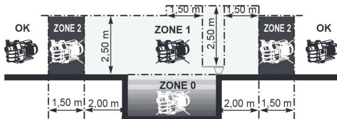
De pomp in een verluchte en droge ruimte installeren, de lucht moet vrijelijk rond de motor kunnen circuleren zodat hij op natuurlijke wijze verlucht kan worden. Regelmäßig controleren of de motorkoeling niet verhinderd wordt door voorwerpen, bladeren of andere obstakels.
